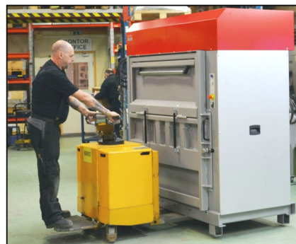
En truck kan flytta maskinen både från sidan och framifrån, vilket är viktigt för en flexibel placering av maskinen.
